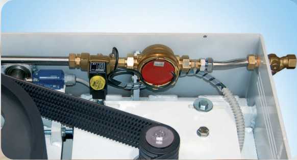
Contaltri acqua/Water counter/Comptable d'eau/Contadores de agua/Wasser-Zähler
